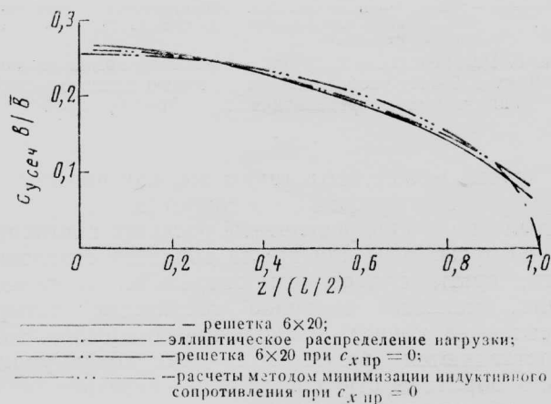
Рис. 4. Распределение нагрузки по размаху крыла при относительном удлинении \lambda=6,32 , угле стреловидности \chi_n=38,2^\circ с профилем NASA 65 1 -213 при a=0,5 , M=0,6 , c_y=0,2 , \psi=6^\circ
