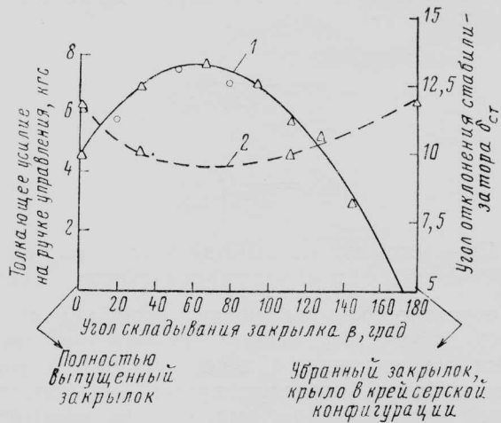
1 — усилие на ручке управления; 2 — \delta_{ст} \Delta - V = 130 км/ч; \circ - V = 148 км/ч
